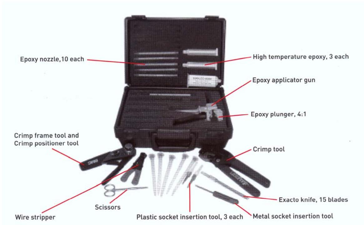
케이블과 커넥터를 현장에서 조립해야 하는 경우에는 상기와 같이 SKPIT를 이용하여 요구되는 밀폐 정도를 유지하여야 합니다. 현장에서 임시로 결선하는 케이블의 경우 절연테이프를 사용하여 케이블의 절연과 밀폐를 시공하는 경우가 종종 있습니다. 이러한 경우 절연테이프 내에 존재하는 접착제가 케이블 내로 침투하여 일정 기간이 경과하면 절연이 파괴되고, 충분히 밀폐가 되지 않은 경우에는 물이나 기름이 침투할 수 있습니다. 침투된 접착제, 물 또는 기름은 절연을 파괴하여 센서의 오동작을 유발하는 원인이 됩니다.
