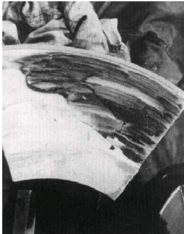
그림 3-92 과부하로 인해 Wiping된 21.75 in(55 cm) Thrust Bearing Pad
