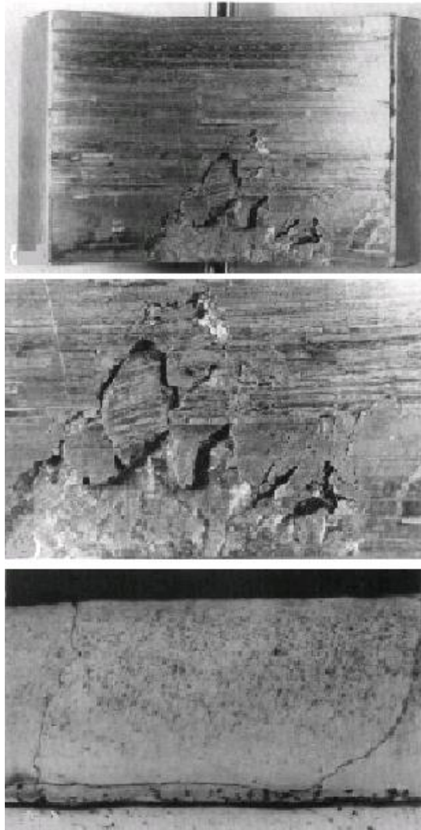
그림 3-82 4-7/8×1-7/8 in(12×4.76 cm) 증기터빈 베어링에서 Edge Loading에 의해 발생된 피로 (a)상부에서 본 그림 (b)Lower Edge의 확대 (c)옆에서 본 그림
