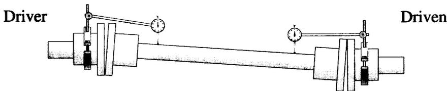
그림 2-35 Shaft-coupling Spool 기법
