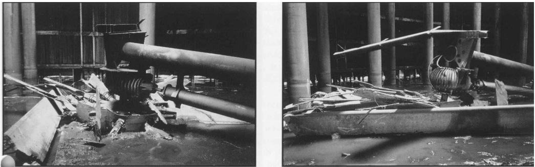
그림 1-5 파괴된 냉각탑 Fan과 기어 감속기
